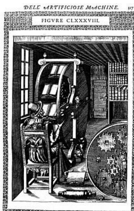
Figure 4 : La machine à lire de Ramelli. Première Roue à livres apparue dans Le diverse et artificiose machine del Capitano Agostino Ramelli, Paris, 1588.
