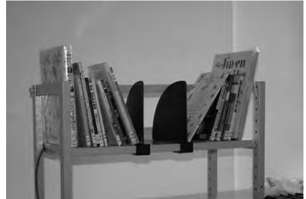
Figure 5 Ergonomies comparatives d'une étagère HF à gauche (une antenne et un lecteur sont capotés dans chaque intercalaire, l'électronique du lecteur crée un ergot sur l'intercalaire) et d'une étagère UHF à droite (les fentes sont invisibles, les intercalaires noirs sont seulement là pour tenir les livres).
